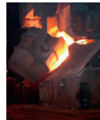
Proces konwertorowy Przedmuchiemy ciekłą surówkę tlenem i wypalimy z niej pierwiastki, głównie węgiel. Aby uzyskać odpowiednią temperaturę do surówki dodajemy żłom. Powstaje stal. Dodatki stopowe pozwalają nam uzyskać stal o odpowiednich właściwościach.
