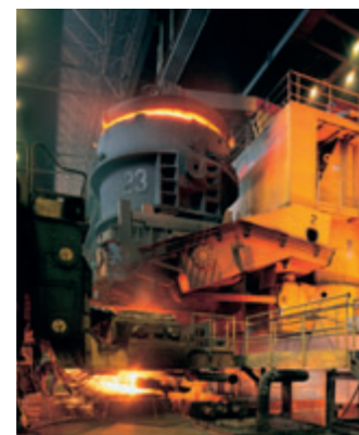
Ciągłe odlewanie stali Wlewamy ciekły metal do krystalizatora, w którym krzepnie. Wyjmujemy go z krystalizatora i tnijemy na odpowiednie długości.
