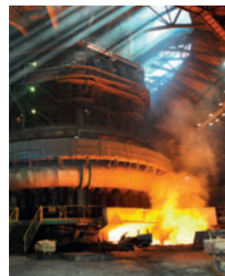
Wielki piec Przetapiamy rudy żelaza oraz inne dodatki na płynną surówkę – mieszaninę żelaza z węglem i innymi pierwiastkami.
